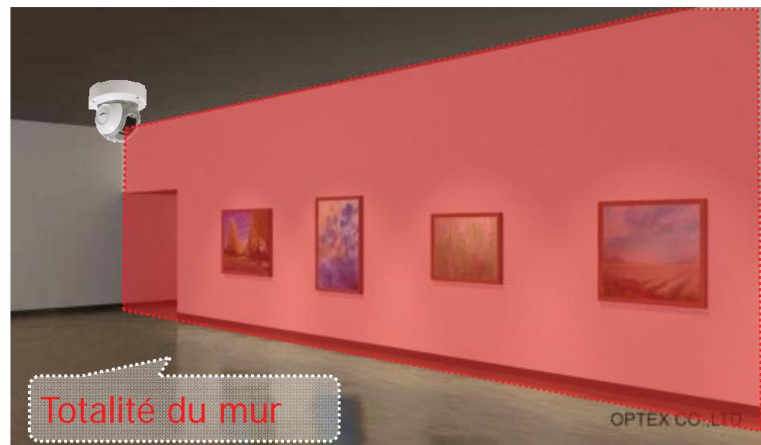
Des modèles de zone de détection multiples sont faits par la fonction avancée mettant la fonction des zones masquée ou des zones allouée. Ceux-ci peuvent être stockés dans l'unité Redscan, les modèles peuvent être commutés par le logiciel de PC, "ChngMaskTask.exe" à distance sur le même réseau (connexion IP) ou contrôlés par VMS, qui peut envoyer des commandes de contrôle ou, via le terminal de saisie sur l'unité lui-même (RLS- 2020S seulement).
