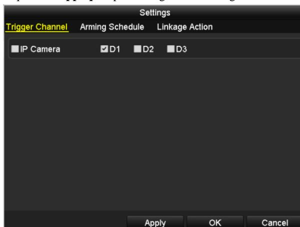
Figure 8. 2 Régler la caméra déclenchée sur détection de mouvement
