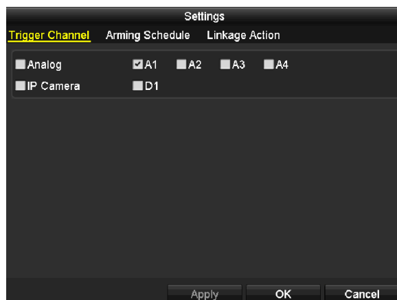
Figure 8. 15 Définition du canal déclencheur de l'alarme VCA
