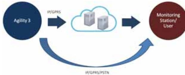
2. **Communication avec Secours:** Le Cloud est le mode de communication principal. Si le Cloud est indisponible, l'Agility passe automatiquement sur ses secours de communication, en fonction des modules installés.
