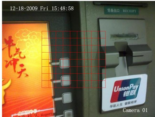
Figure 2. Zone de détection des mouvements
